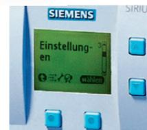
Parametrização simples e rápida através de display gráfico
